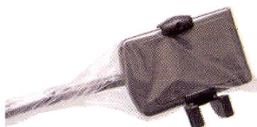
Figure 16 : Utilisation d'une gaine de protection du capteur
